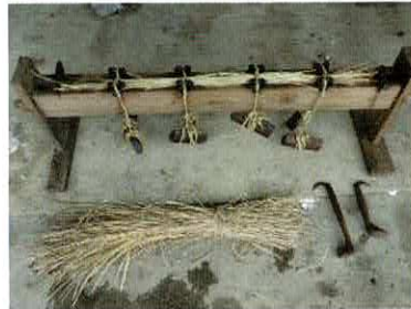
俵編み機：ワラで米60キロ グラム用の米俵を編む機械。
