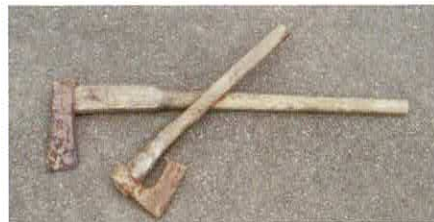
まさかり・おの（鉞・斧）：鉞は柄が長く両手で大きな丸太を割る時に使う。斧は金槌を使うように片手で小さな薪などを割る時に使う。
