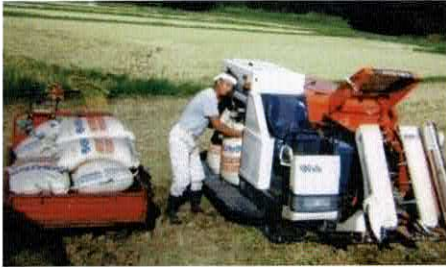
自脱式コンバイン：機械が刈り取りと脱穀を同時に稲を袋詰めにした。自然乾燥から自宅乾燥に。
