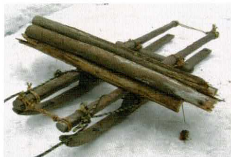
長ぞり：接地面に鉄板を貼って滑りやすくし、冬期間の原木運搬やあらゆる荷物運びに使った。
