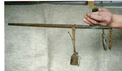
さおばかり(棹秤)：秤の一種。目盛りのある竿の一端に品物を掛け、把手を支点として分銅を移動して竿が水平になった時の目盛りで重さを計った。
