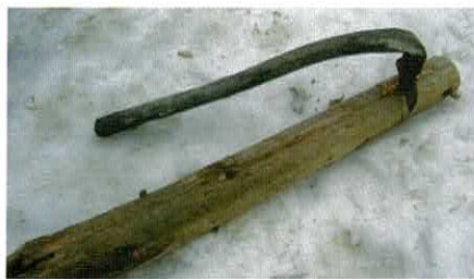
ちょうな（手斧）：丸太を斧で削った後、平らにするために使った大工道具。
