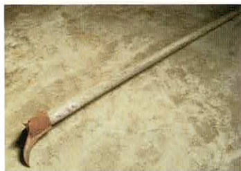
とびぐち（鳶口）：左上は柄が長く、太い丸太を動かす時、中央は、丸太を引っかけて動かしたり細い材を動かした。（使用時写真右）
