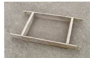
ふるい（篩）：粒状のものを使う大きさによって選り分ける道具。
