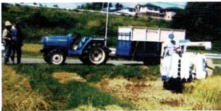
グレン（タンク）付自脱式コンバイン：グレンに稲を溜めてオーガで専用運搬機に送れるようになった。
