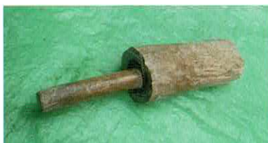
どつき（土突き）：建築をする前に地面を突き固める。大きい物は取っ手が何本も付いていてタコとも言った。
