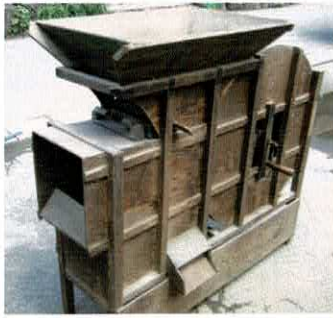
とうみ（唐箕）：上の口から 籾を入れ、風を送り、ちり を飛ばして選別した。
