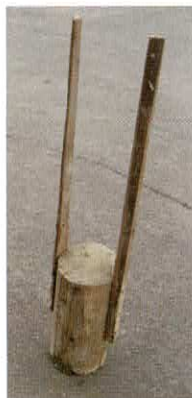
どつき（土突き）：建築をする前に地面を突き固める。大きい物は取っ手が何本も付いていてタコとも言った。
