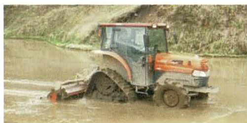
クローラ型トラクター：軟らかい水田にも埋まりにくく農作業が大幅に効率化された。
