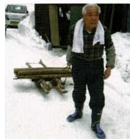
長ぞり：接地面に鉄板を貼って滑りやすくし、冬期間の原木運搬やあらゆる荷物運びに使った。
