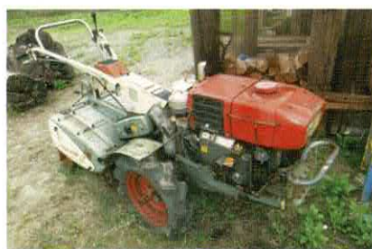
耕耘機：ロータリー式回転で歩行して田畑を耕した。
