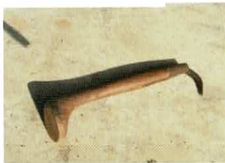
てかぎ（手鉤）：蔦口の一種。 農作業用は、長さ約25cm 程の棒で筋金入りの先口鉤 を付けたもの。主に、米俵を 結う時に用いられた。
