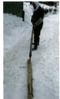
とびぐち（鳶口）：左上は柄が長く、太い丸太を動かす時、中央は、丸太を引っかけて動かしたり細い材を動かした。（使用時写真右）
