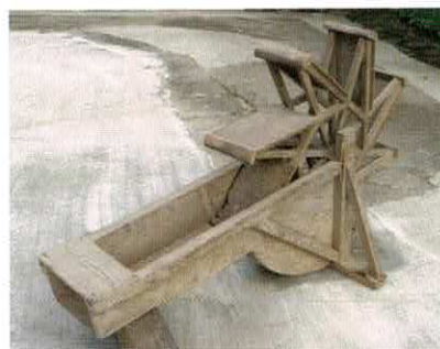
水車：水路より田んぼが高い時に、用水路から田んぼに水を引くための道具。足踏み式と手動式があって、写真は手動式。
