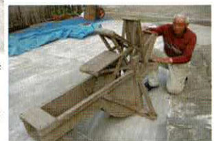
水車：水路より田んぼが高い時に、用水路から田んぼに水を引くための道具。足踏み式と手動式があって、写真は手動式。
