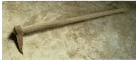
とびぐち（鳶口）：左上は柄が長く、太い丸太を動かす時、中央は、丸太を引っかけて動かしたり細い材を動かした。（使用時写真右）
