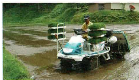
乗用田植機：乗用になり肥料や除草剤が同時に出来るようになり、また改良され5条・6条植えが普通となった。
