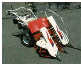
バインダー：手刈りから機械により稲刈りをして束ねる作業ができた。
