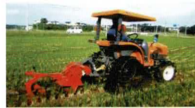
クローラ型トラクターで明渠：平成20年代になり、トラクターに取り付けて明渠掘り。
